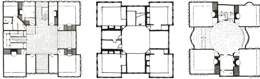
Görsel 26. 1. Dört köşeli orta sofalı plan tipi örneği (Vasıf Bey Konağı, Bolu) (Eldem, 1954, s. 133); 2. Pahlı orta sofalı plan tipi örneği (Gökçüoğlu Evi, Safranbolu) (Sözen, 2001, s.92); 3. Yuvarlak orta sofalı plan tipi örneği (Abacı Yorgi Evi, Filibe) (Eldem, 1954, s. 142)
