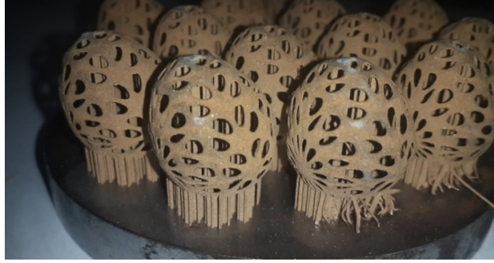
Görsel 9 . Cad ortamında tasarımı yapılan ürünün lazer sinterleme makinesinden çıkmış hali (GÜNER, 2017)
