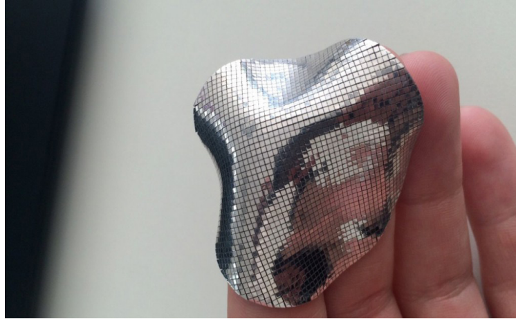
Görsel 12. Lazer sinterleme yöntemiyle üretilmiş kinetik kumaş ( https://www.3d.sisma.com/ , Erişim Tarihi: 01.11.2018)
